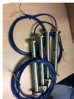
Figura 7.8. Lector de extensómetro de cuerda vibrante; extensómetros de cuerda vibrante; montaje de roseta de extensómetros de cuerda vibrante (cortesía de Iberdrola)
