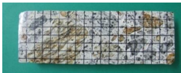
Figura 5.11. Muestra de hormigón preparada para realizar el DRI.
