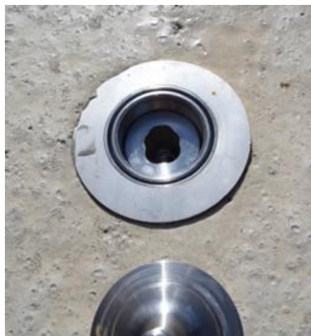
Figura 4.55. Prisma (cortesía de Iberdrola)
