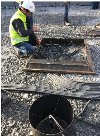
Figura 7.4a y Figura 7.4b. Montaje de una roseta de extensómetros y extensómetro corrector (cortesía de Iberdrola)
