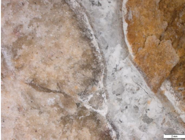
Figura 5.5. Áridos reaccionados con formación de anillo de reacción.
