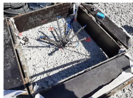
Figura 7.8. Lector de extensómetro de cuerda vibrante; extensómetros de cuerda vibrante; montaje de roseta de extensómetros de cuerda vibrante (cortesía de Iberdrola)
