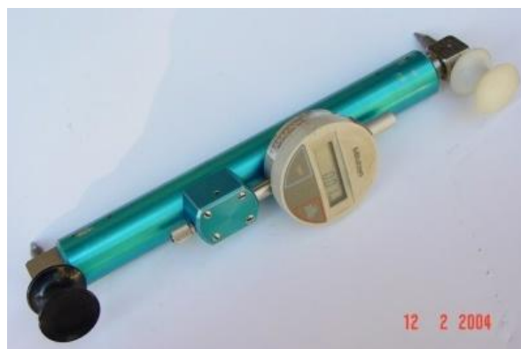
Figura 4.66. Elongámetro digital (cortesía de Iberdrola)
