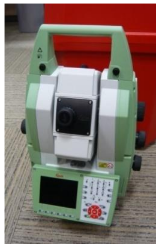
Figura 4.56. Estación topográfica (cortesía de Iberdrola)
