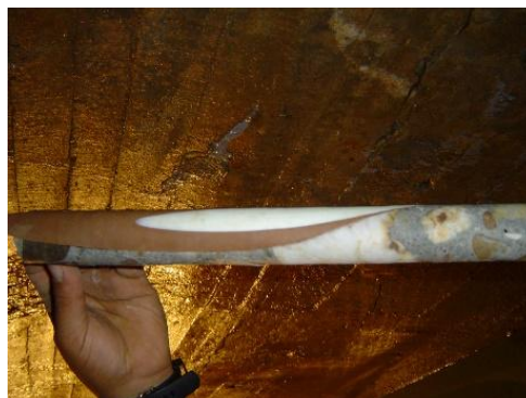
Figura 7.37 Testigo con anclaje de fibra de vidrio inyectado (cortesía de Iberdrola)
