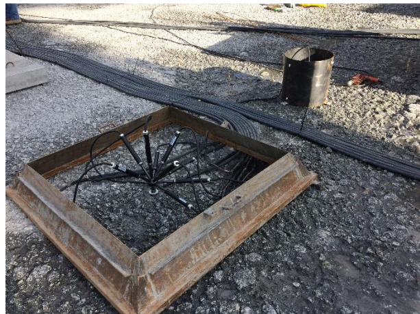
Figura 7.4a y Figura 7.4b. Montaje de una roseta de extensómetros y extensómetro corrector (cortesía de Iberdrola)
