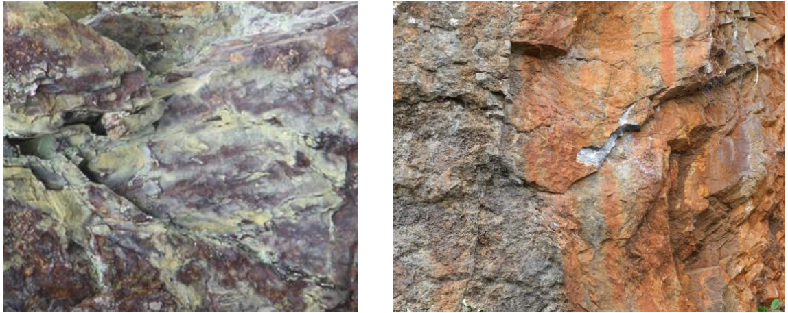
Figuras 4.36 y 4.37. Frente de una cantera con árido reactivo (cortesía A. Aguado)
