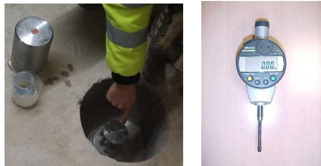
Figura 7.2. Comparador de precisión (cortesía de Iberdrola)
