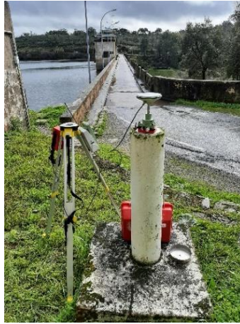
Figura 4.58 GPS en las inmediaciones de presa (cortesía de Iberdrola)
