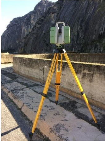
Figura 4.57 Láser escáner en coronación de presa (cortesía de Iberdrola)
