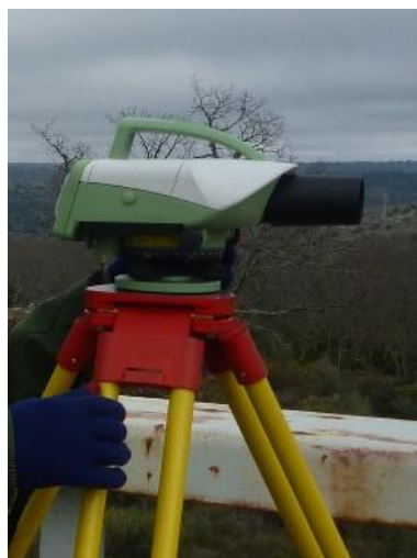
Figura 4.51. Nivel digital LEICA (cortesía de Iberdrola)
