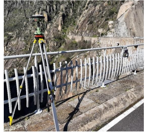
Figura 4.59 GPS en coronación de presa (cortesía de Iberdrola)
