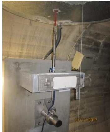
Figura 7.18. Sensor de cuerda vibrante en medidor de convergencia (cortesía de Iberdrola)
