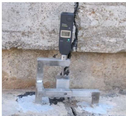
Figuras 4.69 y 4.70. Lectura del medidor mediante comparador digital y medidor tridireccional automatizado (cortesía de Iberdrola)
