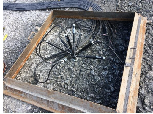
Figura 7.6b. Montaje de una roseta de extensómetros de resistencia (cortesía de Iberdrola)
