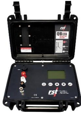
Figura 7.6a. Lector de extensómetros de resistencia (basado en catálogo comercial) https://rstinstruments.com/ (Accessed 2022-01-19)
