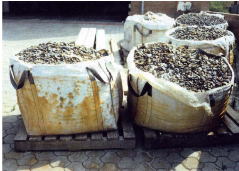
Figura 2.9. Sacos con los áridos con potencial degradación (cortesía A. Aguado)
