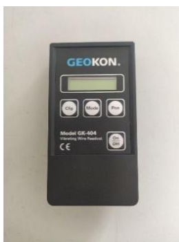
Figura 7.8. Lector de extensómetro de cuerda vibrante; extensómetros de cuerda vibrante; montaje de roseta de extensómetros de cuerda vibrante (cortesía de Iberdrola)
