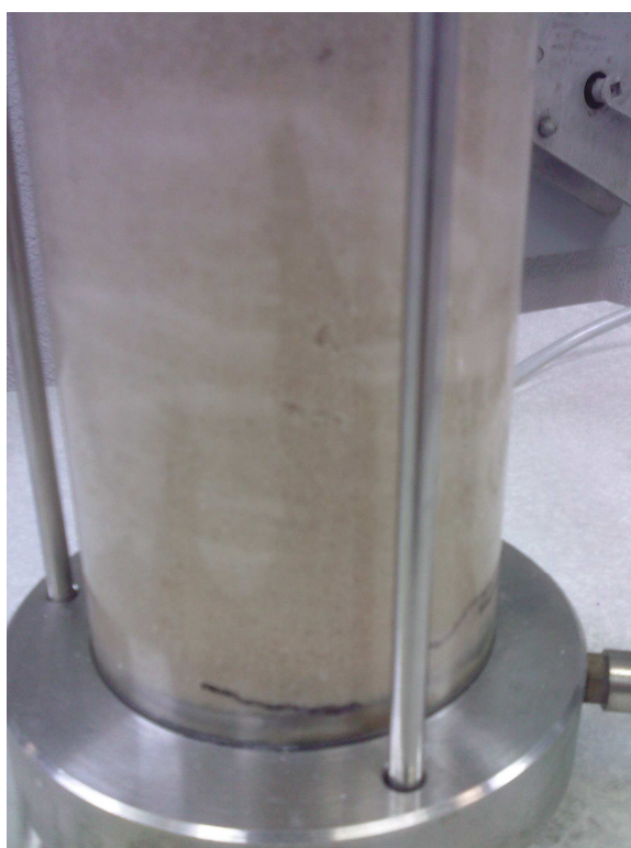
FOTO N° 7 : Avance no uniforme del frente de disolución en el ensayo.
