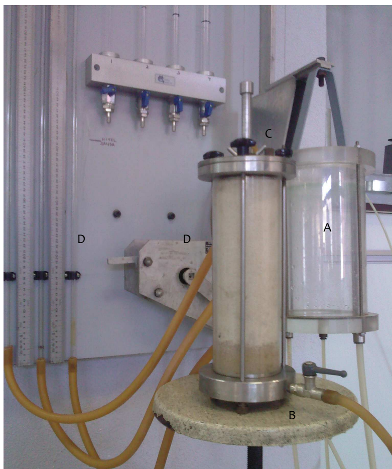
FOTO N° 4 : Permeámetro de carga constante del laboratorio de Geotecnia del CEDEX.
