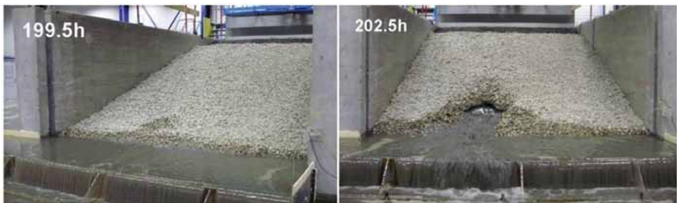
Fig. 8. Ensayo a gran escala de erosión interna
