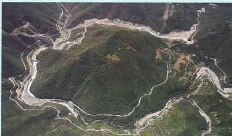
Fig. 13 Presa de Tsakov Kamak y Central hidroeléctrica. El salto se produce en la zona estrecha del meandro.
