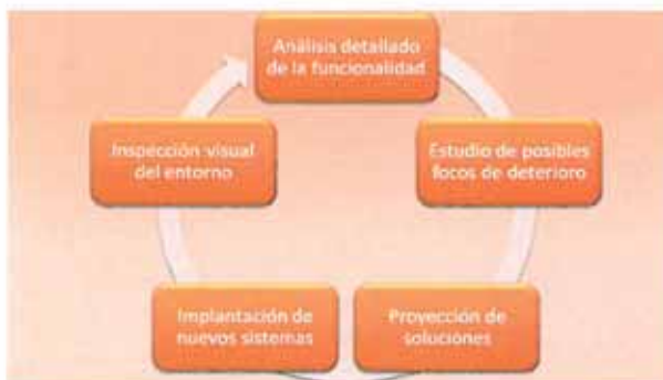
Fig. 12. Proceso de mantenimiento de sistemas de auscultación en presas. Incluiría por Gil, Arguedas y G. Membrillera, en la R26.
