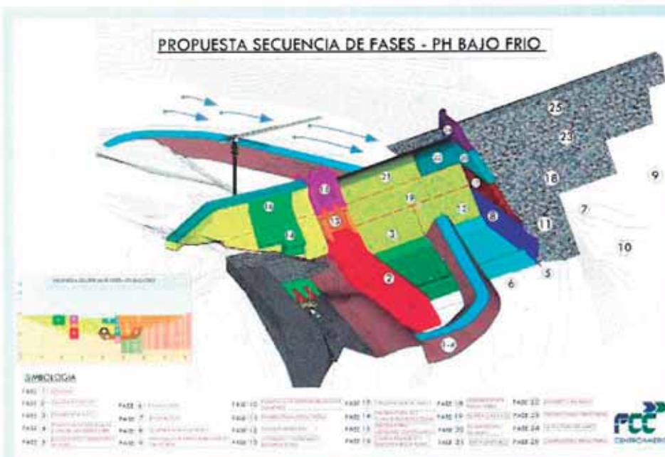
Fig. 25. Presa de La Potra (Bajo Frio). Fases de ejecución de la presa mixta.
