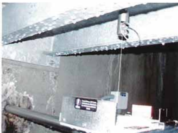
Fig. 11. Ejemplo de problemas de condensación en equipos de medida. Incluiría por Gil, Arguedas y G. Membrillera, en la R26.
