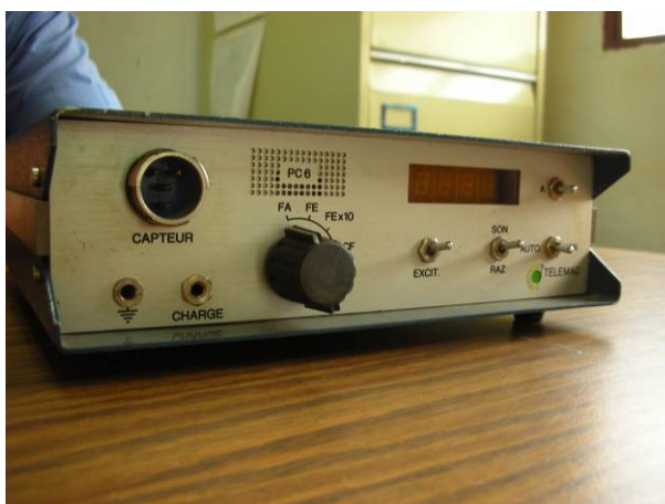
Figura 5.19. Aparato de medición para piezómetros
