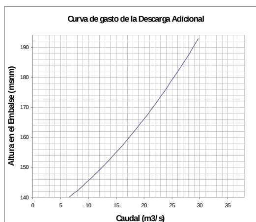
Figura 5.42. Curva de gasto de la Descarga Adicional
