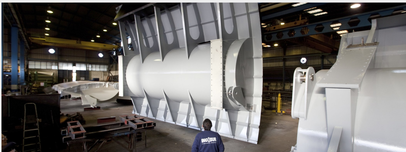
Compuerta Taintor de la presa de Guadalmellato en la fábrica de INGESUR.
