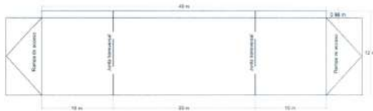
LOSA DE ENSAYO DE HCR - PLANTA
