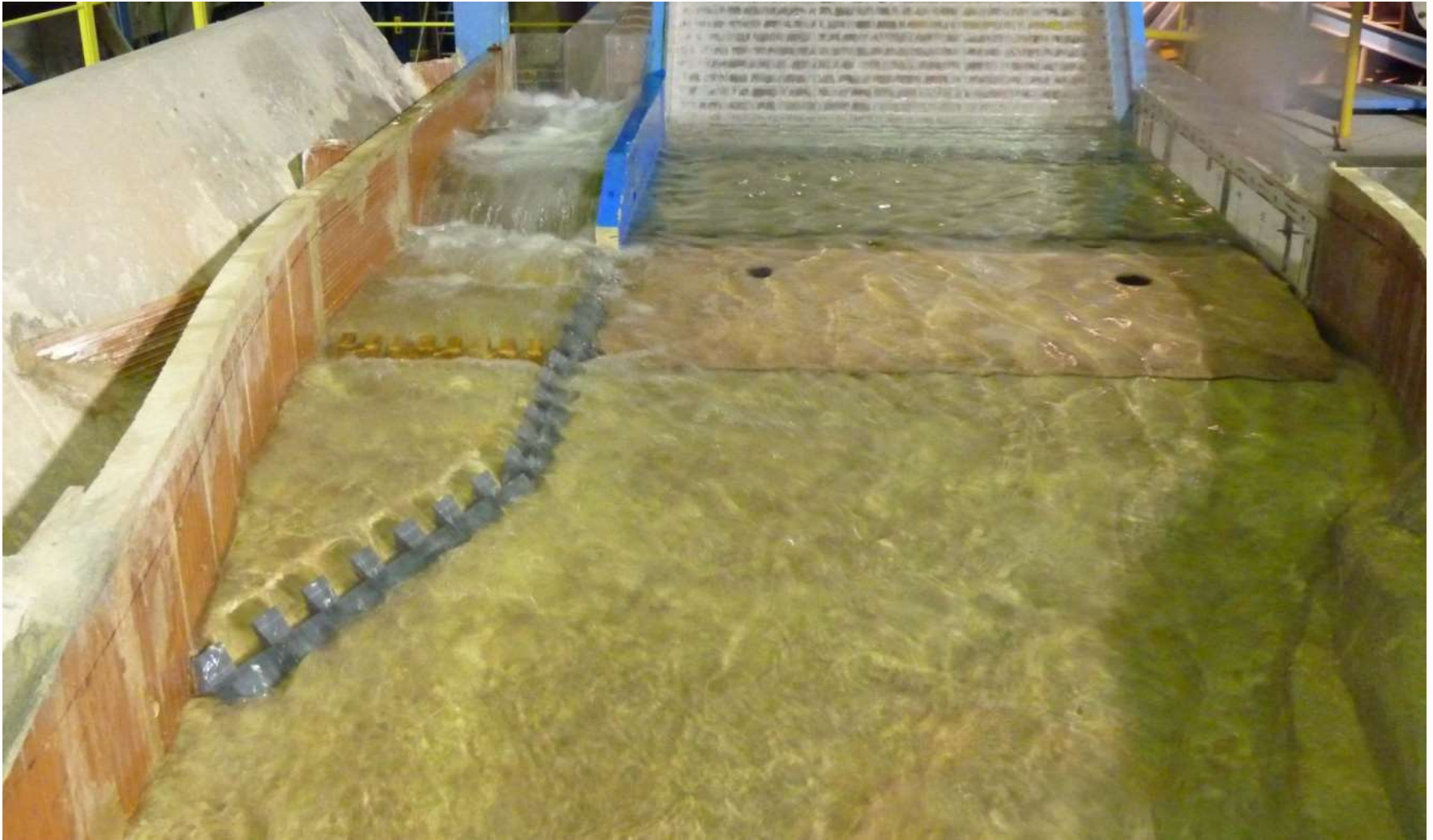
Desagüe de fondo abierto, sin vertido por el aliviadero
