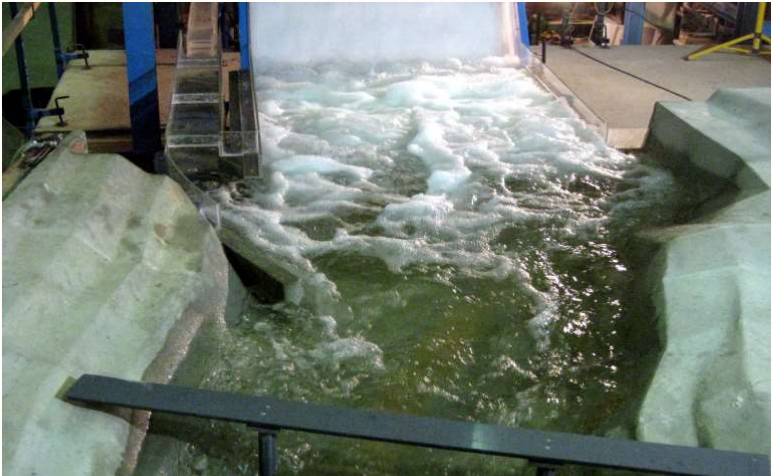
Avenida extraordinaria. Desagüe de fondo cerrado
