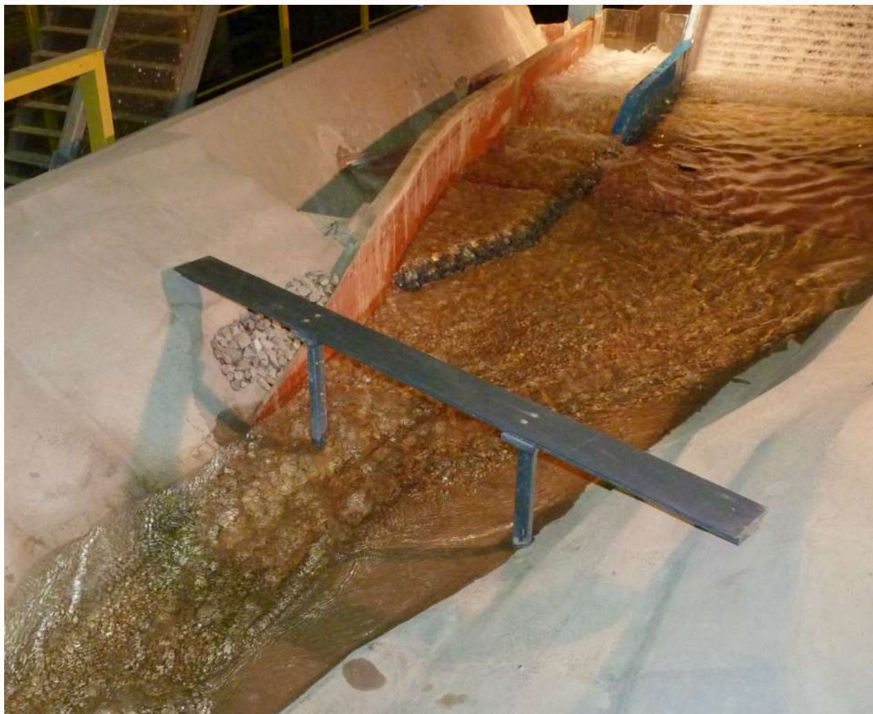
Desagüe de fondo abierto, sin vertido por el aliviadero
