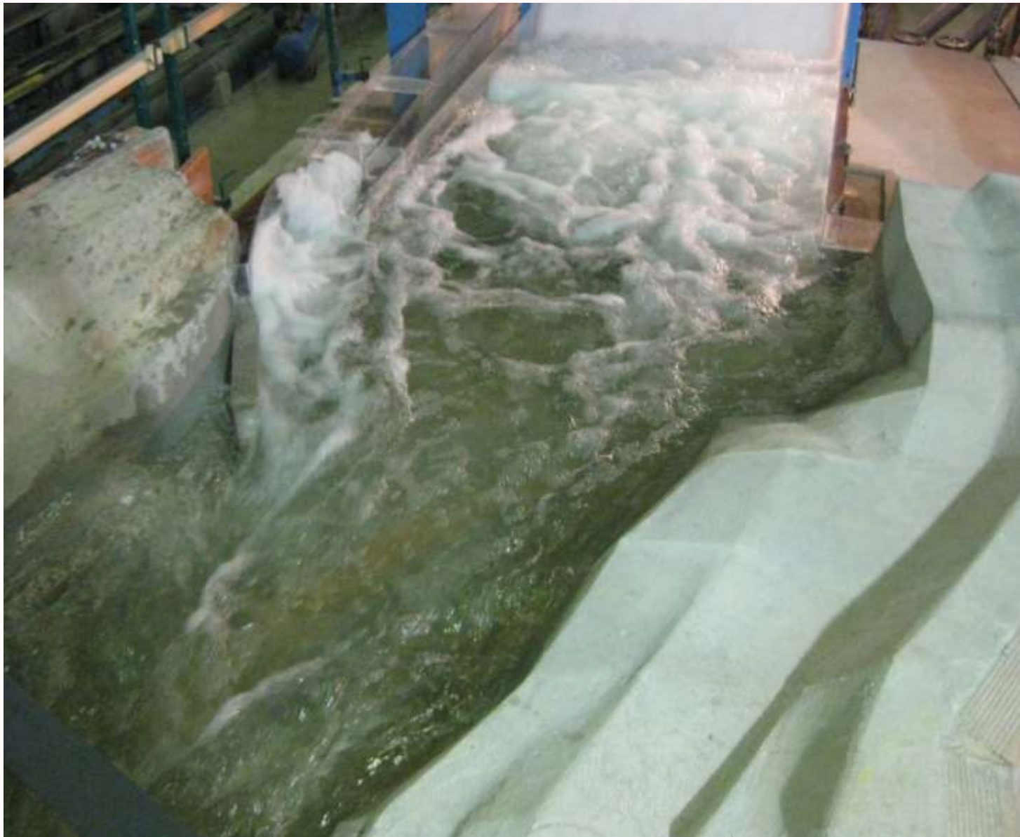
Desagüe de fondo abierto, avenida de proyecto por el aliviadero
