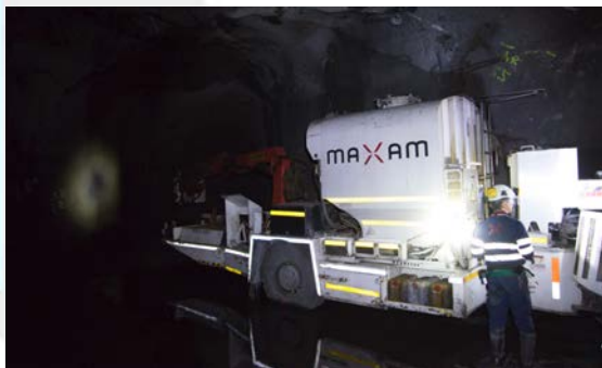
Voladura en abanico. Carga mecanizada de explosivo
