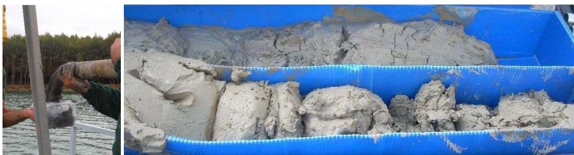
Figura 3: Sedimento muy compacto.
