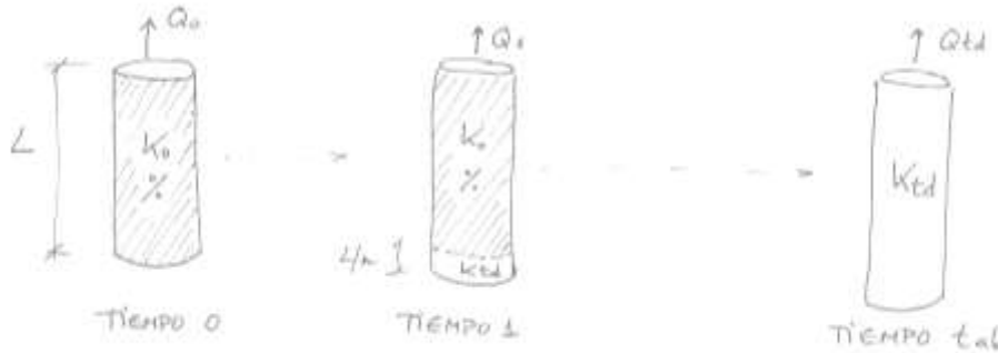
FACTOR DE ACELERACIÓN PARA UN CILINDRO DE SUELO CON n_0=0,2
